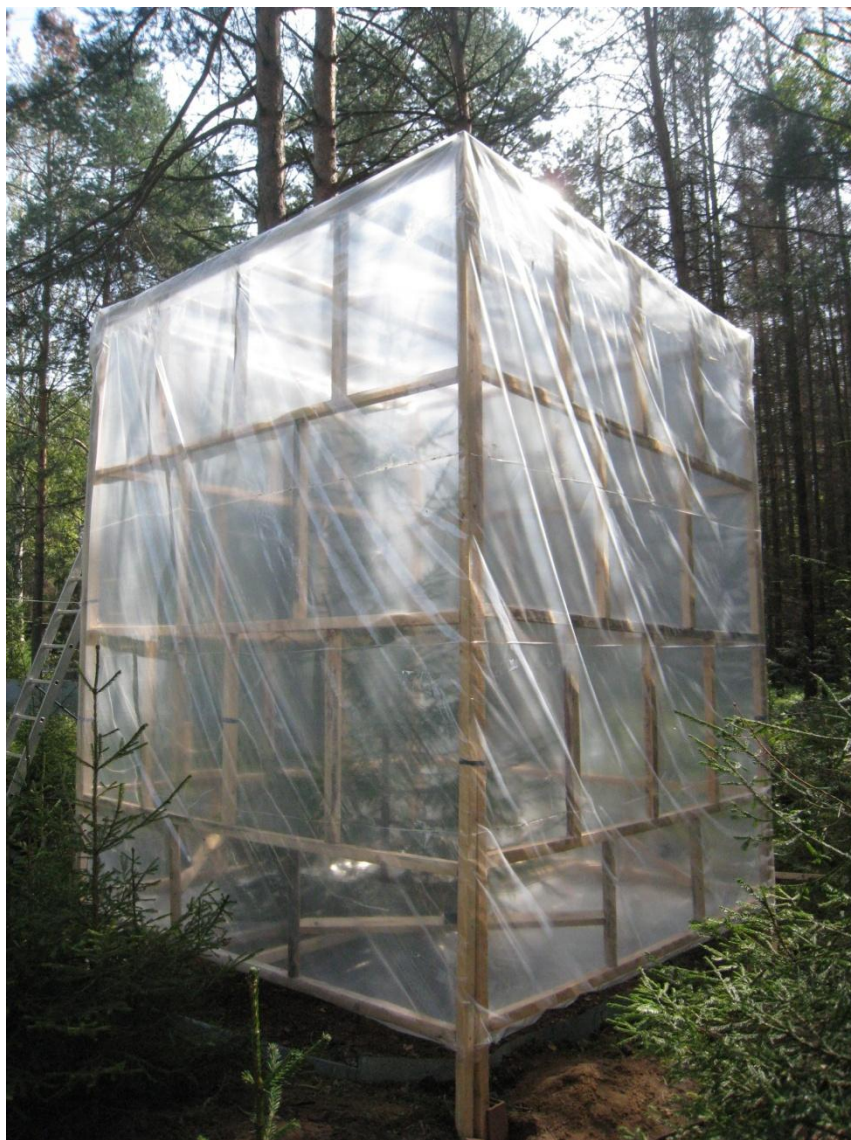
Рисунок 5.1. Полипропиленовая камера, установленная вокруг кроны ели в эксперименте.
